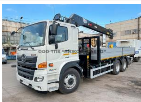
Кран-манипулятор Hino 500 FM с КМУ Hiab 190TM-6 (п.м 26 т)
