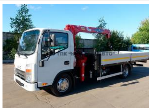
Кран-манипулятор JAC N56 с КМУ Maeda 263 (п.м 3.5т/5.6т)
