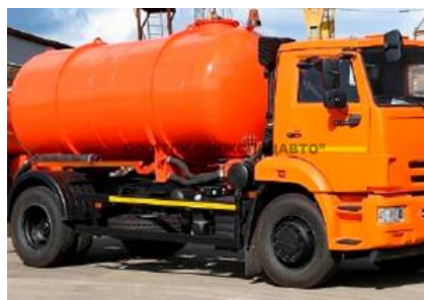
Ассенизатор АКН - V8000л на базе а/м КАМАЗ 43253
