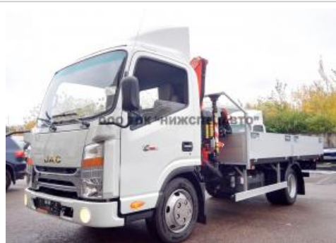
Кран-манипулятор JAC N56 с КМУ Fassi F40B.0.22 (п.м 3.5т/5.6т)
